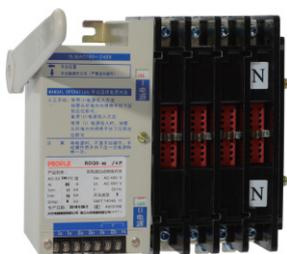
RDQ6双电源自动转换开关，适用于交流50/60Hz，额定工作电压380V，额定工作电流2500A以下的供电系统。可根据需求进行两路电源之间的选择转换（常、备电源可以是电网，自动发电机组，蓄电池等，常、备电源由用户自定）。产品适用于国家规定的特级或一级负荷用户，如高层楼宇、邮电通讯、煤矿船舶、工业流水线、医疗卫生、军事设施、机场、消防、冶金、化工、纺织、石油等不允许停电的重要场所。
