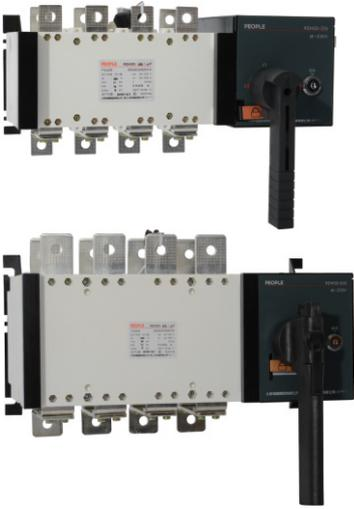
RDH5D双电源自动转换开关(ATSE),是集开关与逻辑控制于一体、真正实现机电一体化的新型自动转换开关;它适用于交流50Hz、额定电压AC400V、约定发热电流至3200A的工业企业配电设备中,具有电源检测、保护、电气机械互锁等功能;可实现全自动、远程控制,强置“0”、紧急手动等操作,广泛应用于供电系统,将负载电路从一个电源自动换接至另一个(备用)电源的开关电器,以确保重要负荷连续、可靠运行及安全隔离等。开关由控制线路板发出各种逻辑命令管理电机,由电机带动开关主体部分的操作机构,快速地接通与分断电路或进行电路转换,通过明显可见状态实现安全隔离。
